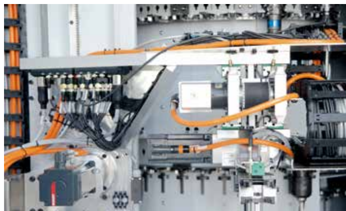
AM8000シリーズのサーボモータは、コンパクトな設計とワンケーブルテクノロジーにより、省スペース化とスタートアップに要する時間の短縮を実現する
