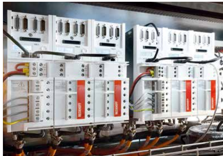
Valka社はカッティングロボットの動作をEtherCATサーボドライブAX5203によって制御する
