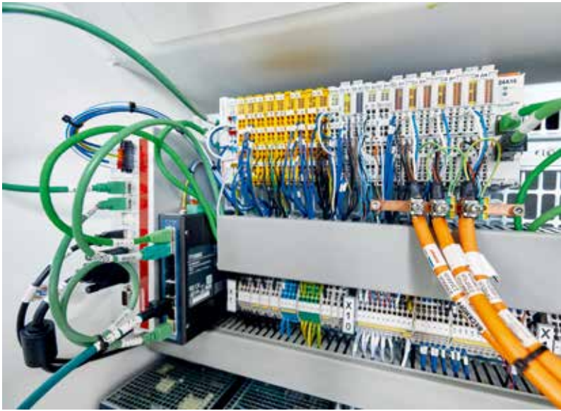
コンパクトなオールインワン制御:C6920 制御盤型IPC およびセーフティおよびドライブテクノロジーを内蔵したモジュール型EtherCAT I/Oシステム
